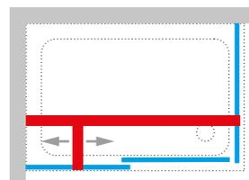
2 Set Stabilisierungsstange zur "T" Befestigung
