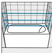
Die Maße von der Wand bis zum Außenrand der Wanne ermitteln. Die Messung ist bei verflieserter Wand und verlegtem Fußboden nach der angeführten Skizze vorzunehmen.
