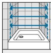
Vermessen Sie den Abstand von Wand zu Wand im unteren, mittleren und oberen Bereich und benützen Sie den niedrigeren Wert. Die Maße sollen von schon fertig verfliesten Wänden nach den aufgeführten Skizzen abgenommen werden.
