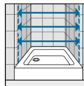
Vermessen Sie den Abstand von Wand zu Wand im unteren, mittleren und oberen Bereich und benützen Sie den niedrigeren Wert. Die Maße sollen von schon fertig verfl iesteten Wänden nach den aufgeführten Skizzen abgenommen werden.
