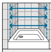
Vermessen Sie den Abstand von Wand zu Wand im unteren, mittleren und oberen Bereich und benutzen Sie den niedrigeren Wert. Die Maße sollen von schon fertig verfliesen Wänden nach den aufgeführten Skizzen abgenommen werden.
